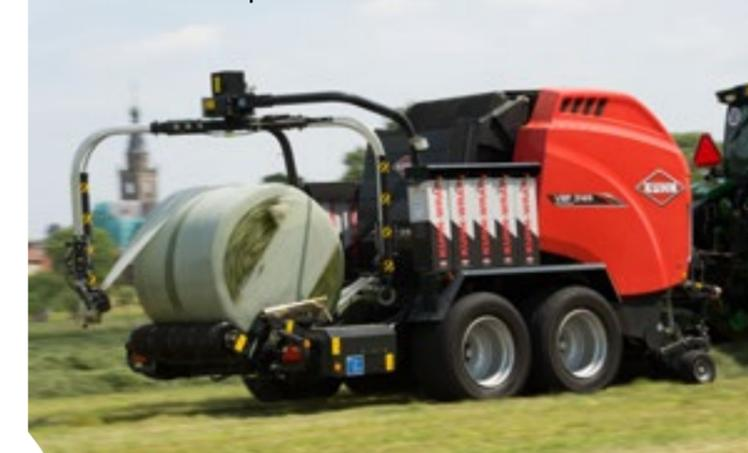
Risultato: una balla molto densa, con un nucleo giustamente soffice e uno strato esterno molto compatto. Sta di fatto che i modelli top di gamma della serie VB 3100 - viene precisato - sono capaci di produrre balle di maggiore densità, con un aumento del loro peso che arriva fino al 10 per cento su foraggi secchi.
