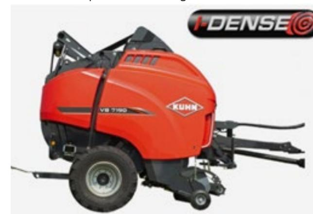
borate dal sensore di umidità, adegua automaticamente la pressione di lavoro in base alle diverse coltivazioni e alle loro condizioni, senza necessità di intervento dell'operatore.
