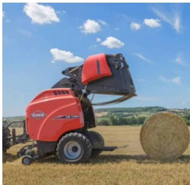
mina una costante tensione della rete durante l'intero ciclo di legatura a tutto vantaggio di una stabile formazione della balla: sistema di legatura che può essere caricato su entrambi i lati della macchina.
